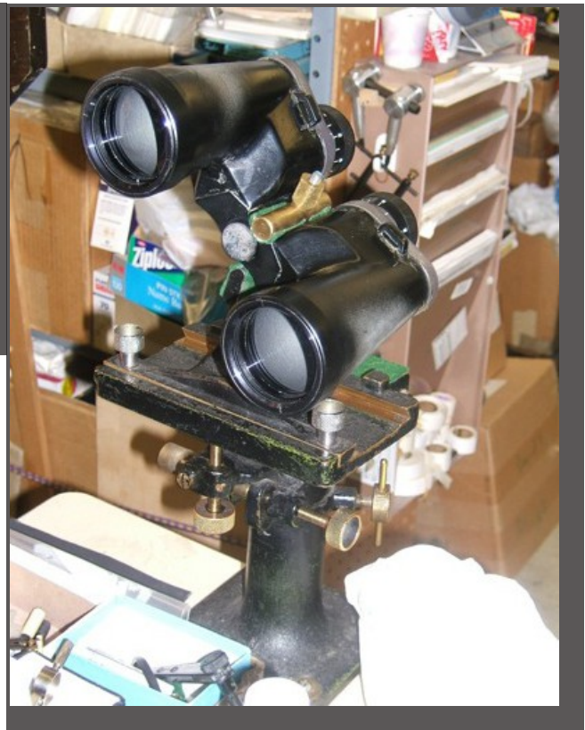
Figura 10. Il banco di prova Mk 5 con un Fujinon MTR-SX fissato in posizione di collimazione.
