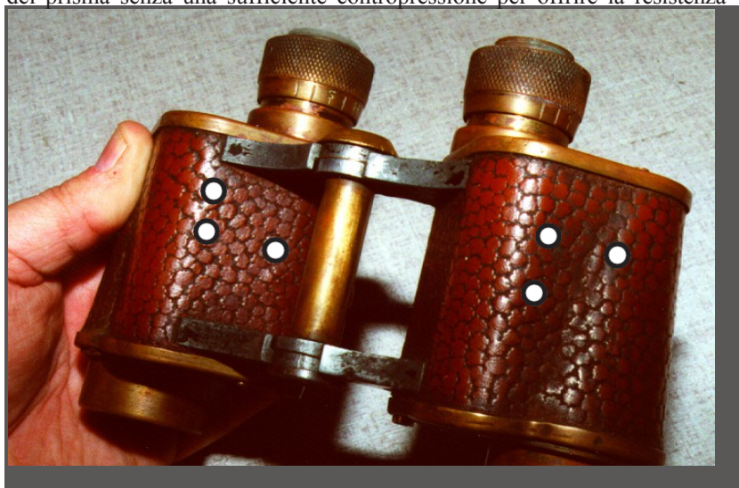
Figura 21. Questo binocolo 6x30 dell'esercito americano dei primi del Novecento è stato progettato per essere collimato da viti di regolazione del prisma passanti nel corpo. I punti bianchi indicano la posizione di 6 viti di collimazione su un lato del binocolo. Non ne indicano altre 6 su questo lato o diverse sull'altro!
