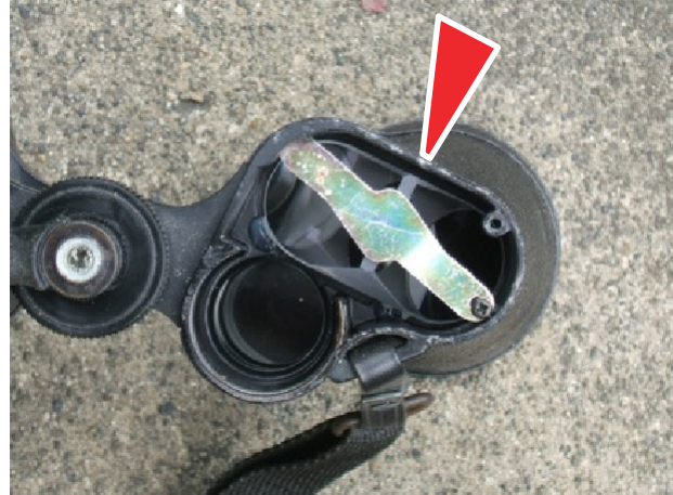
Figura 20. Il triangolo rosso illustra la posizione della vite di collimazione superiore. Come si può notare, la vite passa attraverso il corpo del binocolo appena sopra il centro del prisma superiore. Una molla piatta fornisce una contropressione.
