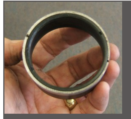
Figura 15. Foto di una tipica cella obiettivo ad anello eccentrico. Utilizzate per la maggior parte del XX secolo, sono ancora oggi in uso su molti strumenti di qualità superiore.
