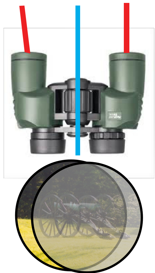
Figura 31. Anche piccole differenze nel parallelismo dei gli assi ottici causano un'immagine sfocata.
