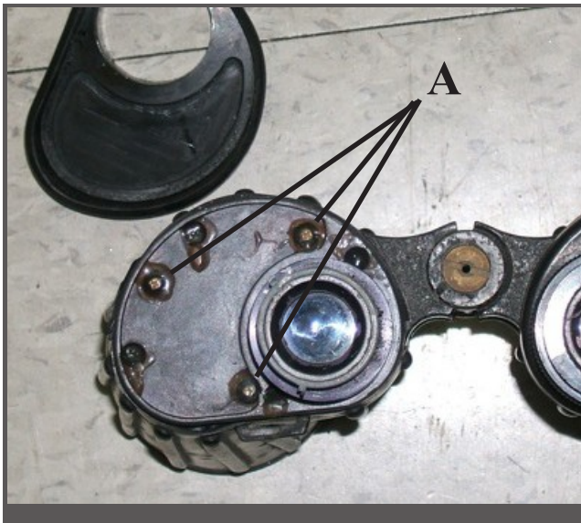
Figura 22. Questa è una foto della piastra posteriore di un binocolo marino Swift Seahawk che mostra le porte di regolazione della collimazione.
