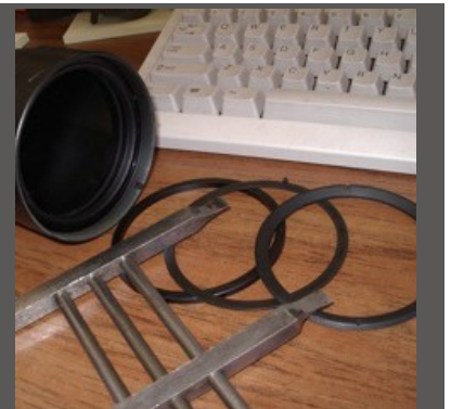
Figura 18. Questa foto illustra il anelli che tengono in posizione un obiettivo Fujinon SX. L'anello più a sinistra funge in qualche modo da cuscinetto. La linguetta in cima al secondo anello si inserisce in una fessura nella parete dell'alloggiamento dell'obiettivo, in modo da evitare che il binocolo col- lato perda il suo allineamento quando si avvita l'ultimo anello di fissaggio.
