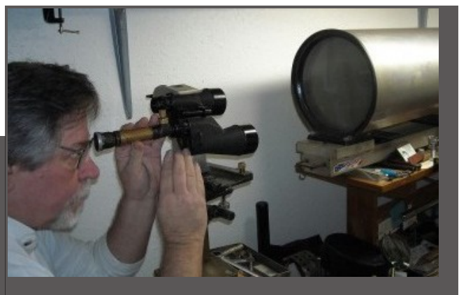
Figura 12. L'aspetto più importante di qualsiasi lavoro di collimazione è l'abilità del tecnico che lo esegue, o come afferma il manuale d'uso dell'Mk IV: "Questo fornisce un metodo conveniente di regolazione con una precisione che dipende dall'abilità dell'utente di sovrapporre un'immagine senza permettere ai suoi occhi di compensare un errore".
