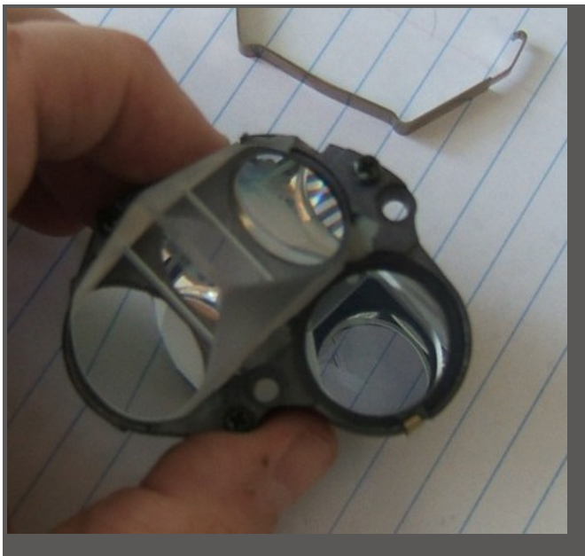
Figura 26. Questa foto mostra un prisma che si è appoggiato in un gruppo di prismi che può essere rimosso dal binocolo.
