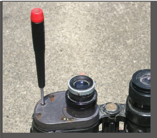
Figura 23. Questo è lo stesso binocolo. Il cacciavite è inserito in una delle 3 viti di collimazione.
