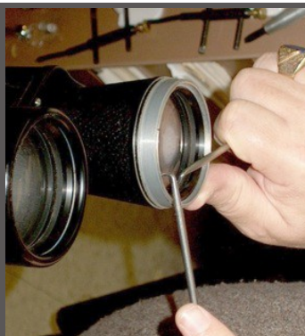
Figura 17. A partire dagli anni '50, binocoli di tutte le dimensioni hanno iniziato ad affollare il mercato. In questo modo, gli strumenti progettati per lavorare con uno o due modelli, come quello della Figura 16, sono caduti in disuso. Qui regolo gli anelli eccentrici usando dei "grimaldelli", come farebbe un macchinista per incidere il metallo.
