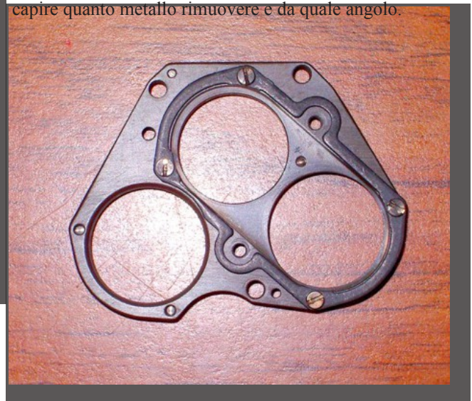
Figura 27. Foto del ripiano per prismi di un binocolo Mk 28 7x50 della Marina. I due fori per le viti vicino al centro del ripiano dei prismi sono per i "pali dei prismi" che tengono gli "schermi" per coprire le superfici riflettenti.
