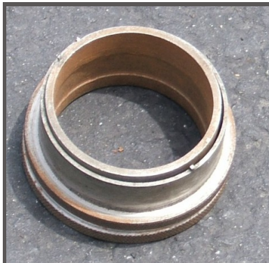
Figura 16. Durante la Seconda guerra mondiale Guerra, strumenti come quello qui sopra hanno aiutato molto nella collimazione. Permettevano di regolare simultaneamente gli anelli eccentrici mentre il tecnico osservava il reticolo attraverso lo strumento.
